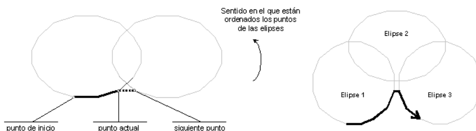
Figura 5.6: Generación de un contorno único a partir de la detección de intersecciones entre aristas.
